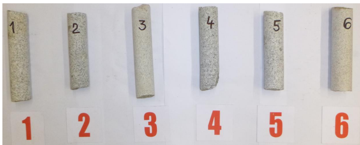
FOTO č.3.1: Dokumentace vzorků pro destruktivní zkoušky kamene opěr
